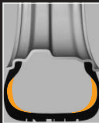
SSR-Pannenlaufreifen Die verstärkten Seiten- wände stützen den Reifen bei Luftverlust.
